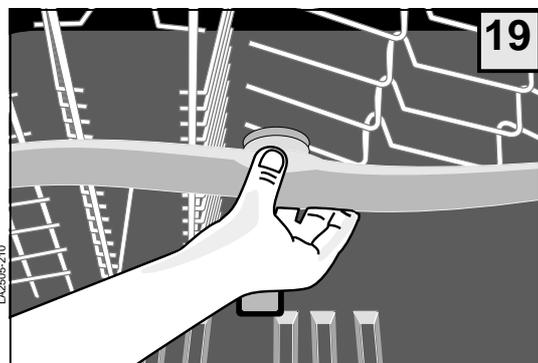
Чтобы снять верхний распылитель: поверните суппорт распылителя против часовой стрелки
