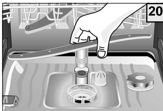
Чтобы снять нижний распылитель: потяните распылитель вверх и снимите его
