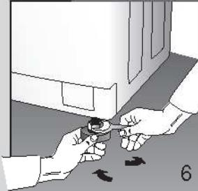
Выберите подходящее место и отрегулируйте машину по уровню при помощи регулируемых ножек (Рис. 6).
