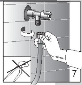
**Прим.** В электронных стиральных машинах, оборудованных двойным электроклапаном (горячей и холодной воды), соедините красную трубку с краном горячей воды, а другую трубку - с краном холодной. Если кран горячей воды использовать нельзя, обе трубы должны быть подсоединенены к крану холодной воды при помощи специального прилагаемого патрубка (смотри рис. 8).
