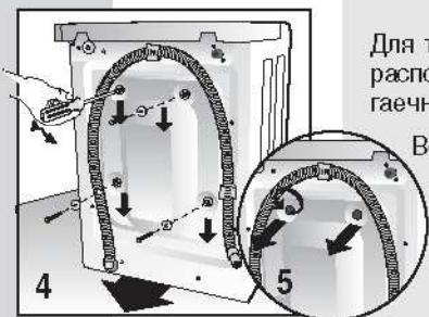
Для транспортировки прибора его качающийся узел блокирован 4 распорками с болтами. Прежде чем подключить машину, при помощи гаечного ключа следует вынуть транспортировочные болты.
