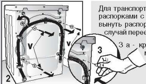
Для транспортировки прибора его качающийся узел блокирован 4 распорками с болтами. Прежде чем подключить машину, следует вынуть распорки и транспортировочные болты и сохранить их на случай переезда.
