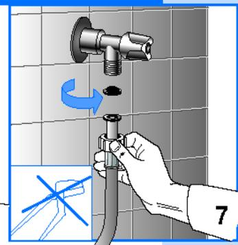
**Прим.** В электронных стиральных машинах, оборудованных двойным электроклапаном (горячей и холодной воды) соедините красную трубку с краном горячей воды, а другую трубку - с краном холодной. Если кран горячей воды использовать нельзя, обе трубки должны быть подсоединены к крану холодной воды при помощи специального прилагаемого патрубка (смотри рис. 8).
