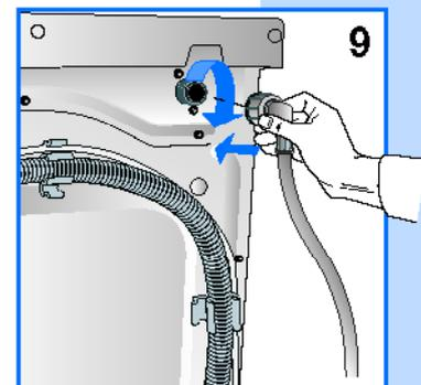
**Прим.** Использовать новую трубку, прилагаемую в комплекте к машине.
