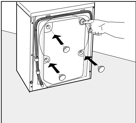
Для транспортировки качающейся узел машины зафиксирован 4 распорками на винтах. Перед тем как приступить к использованию машины, открутите блокировочные винты и выньте их вместе с блокировочными распорками. Сохраните винты и распорки для возможных переездов в будущем.
