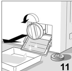
**стиральная машина была опорожнена. Не вынимайте фильтр во время работы машины, или когда бак машины заполнен водой.** Положите под фильтр тряпку или плоский поддон для сбора остатков воды из фильтра. Откройте крышку фильтра, открутите фильтр против часовой стрелки и выньте его [рис. 11]. Необходимо периодически очищать фильтр. Ополосните фильтр под проточной водой и очистите его от всех загрязнений. Прикрутите фильтр по часовой стрелке и проверьте, чтобы он был закрыт герметично.
